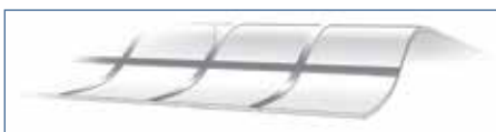
Metal-Mesh-Leiterbahnen: Je engermaschiger das Metallgitter oder je dicker und breiter die Metallbahn, desto höher die Leitfähigkeit.
