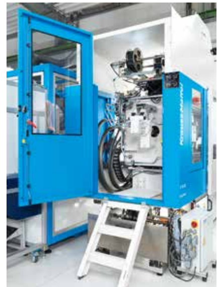
Bild 6. Die Zweiplattenmaschinen der CX-Baureihe nutzen die Aufstellfläche für das IMD-Verfahren sehr gut aus und gewährleisten mit der Auswerferräumtür eine gute Zugänglichkeit zu allen Komponenten
