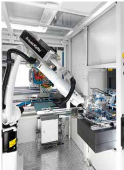
Bild 5. Kompakte Automation: Ein Sechsbachsroboter legt die Bauteile in die Laser-Beschnittstation. Im Hintergrund zu sehen: das Förderband mit UV-Tunnel und dahinter die Schließeinheit mit Folienvorschub
