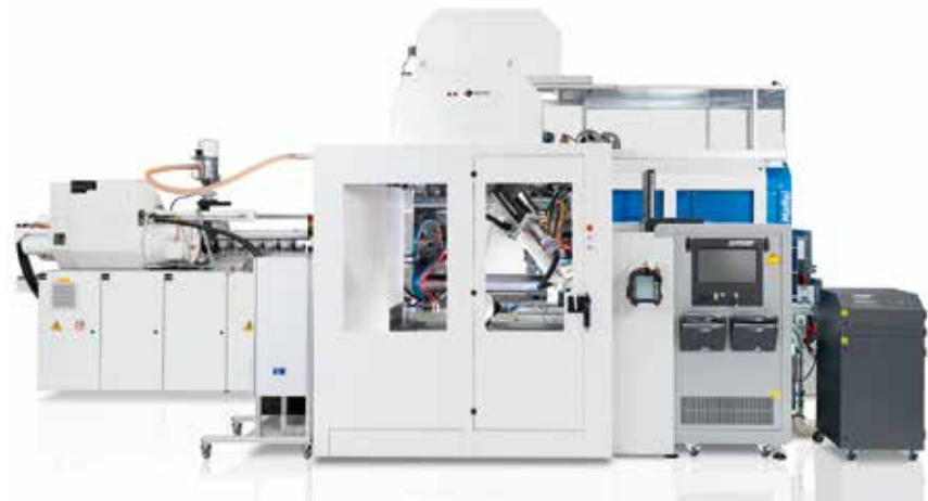
Bild 1. Kompakt und flexibel zugleich: Die vollelektrische PX 320 mit integrierter Automationszelle kombiniert das IMD- mit dem IML-Verfahren (© KraussMaffei)
