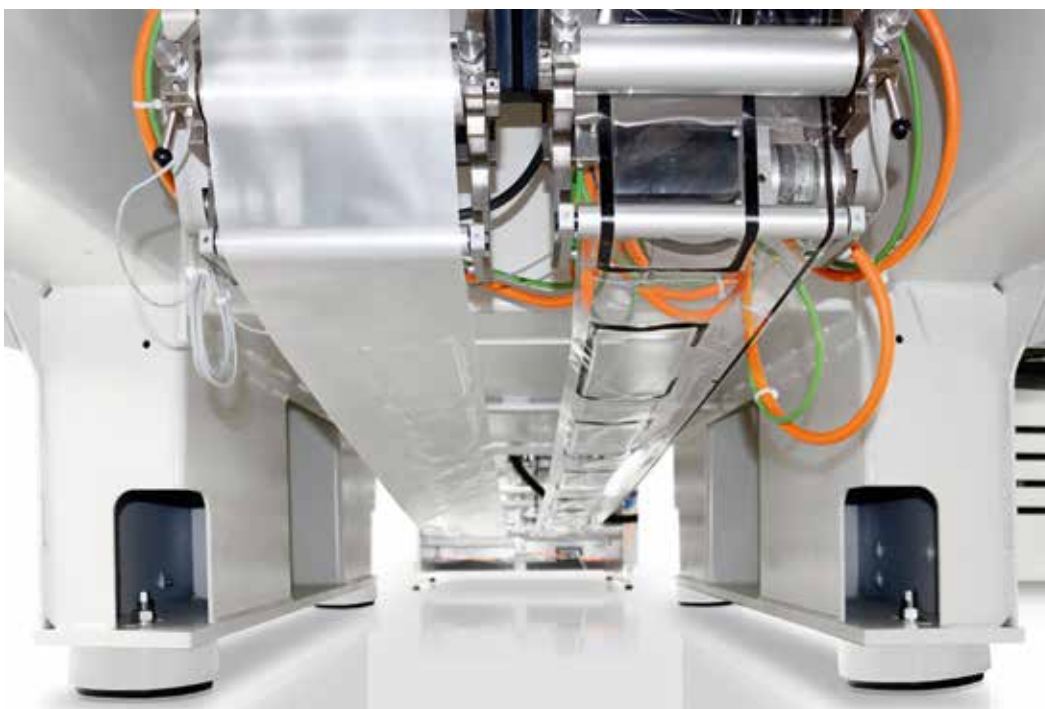
Der Freiraum unterhalb der Schließeinheit schafft die Voraussetzungen für die Folienführung, auch für Anwendungen mit zwei Folienbahnen
